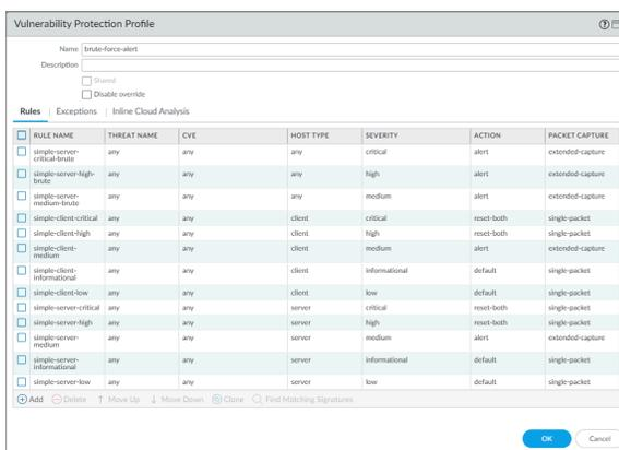
图 1: 暴力破解警报漏洞保护配置文件
